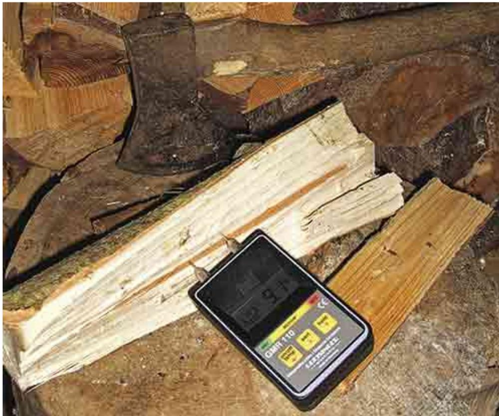
Hier sehen Sie das Feuchtemessgerät beim Messen mit den internen Messnadeln
