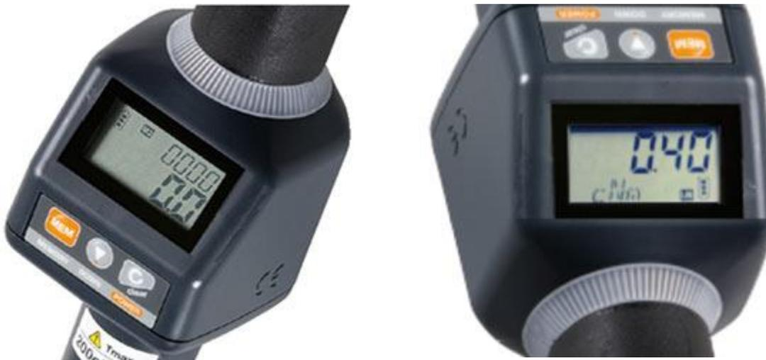
Hier sehen Sie das programmierbare, digitale Display, vom Drehmoment-Schraubendreher, welches je nach Einsatz verändert werden kann, sodass aus verschiedenen Punkten abgelesen werden kann.
