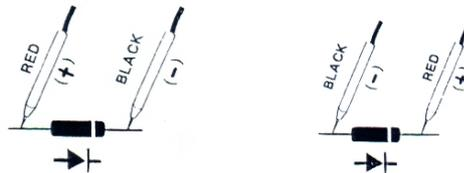
Wenn die Prüfleitungen wie in Abb. 2 zu sehen angelegt werden, wird eine Rückwärtsmessung der Diode durchgeführt. Wenn die Diode heil ist, wird ein „OL“ angezeigt. Wenn die Diode defekt ist, erscheint eine „.0000“ im Display. Bei einer Diodenmessung sollten immer beide Prüfwege benutzt werden.
