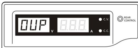
Zum Zurücksetzen der Warnmeldung schalten Sie das Gerät aus und entfernen Sie alle Lasten. Schalten Sie das Gerät wieder ein. Das Gerät nimmt den normalen Betrieb wieder auf. Bleibt das Problem bestehen, wenden Sie sich bitte an Ihren Fachhändler.
