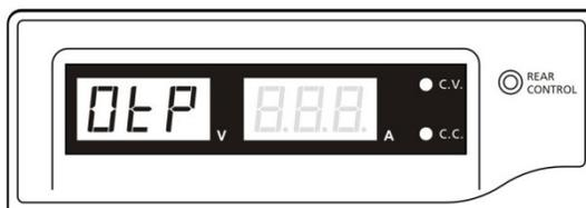
Überprüfen Sie die Last und die Ausgangsleistung. Lassen Sie das Gerät mindestens 30 Minuten abkühlen.
