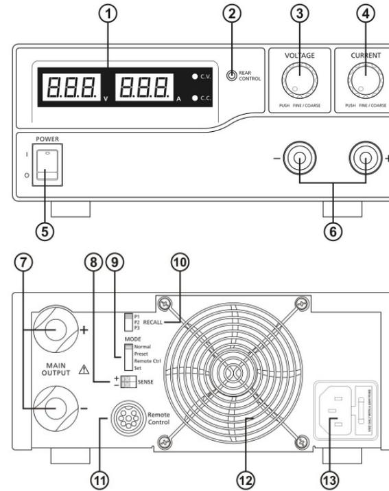
1. LED-Anzeige für Strom und Spannung mit CC/CV-Anzeigen
