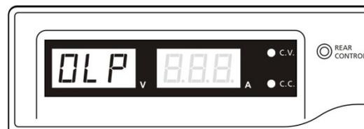
Zum Zurücksetzen der Warnmeldung schalten Sie das Gerät aus und entfernen Sie alle Lasten. Schalten Sie das Gerät wieder ein und überprüfen Sie sein Funktionieren mit Vorsicht.
